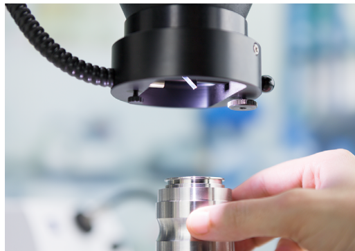
Untersuchen Sie Bohrungen, Gewinde und Vertiefungen mit dem Vertikalilluminator S. Dessen 45°-Spiegel ist verstellbar, um Vignettierungseffekte zu unterdrücken.
